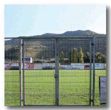
Cancello a due ante di dimensioni cm. 260x220 in tubolare in acciaio S235JR (Fe 360B) zincato. Ciascuna anta è composta da telaio perimetrale in acciaio zincato, a sezione rettangolare o quadrata, con traverso orizzontale in acciaio zincato. Pannellatura interna realizzata in tondini e piatti in acciaio zincato, a maglie di dimensioni 200x50 mm.
